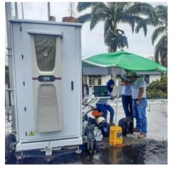
Con el fin de mantener las estaciones en óptimas condiciones, se realizaron las actividades propias de las rutinas de mantenimiento periódico de las cuatro estaciones del SVCA, las cuales consisten en pruebas de fugas, verificación y ajuste de flujo, cero y span. De igual manera para las siete microestaciones de Olores Ofensivos, se realizaron actividades de verificaciones de las mediciones y rutinas de mantenimientos preventivos.
