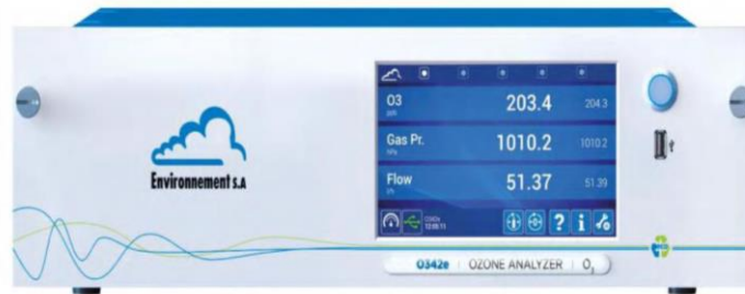
Imagen 7. Analizador de Ozono Troposférico Envea O342e
