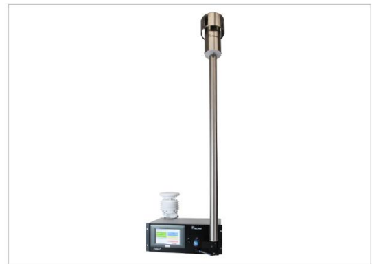
Imagen 3. Analizador de partículas Fidas 200
