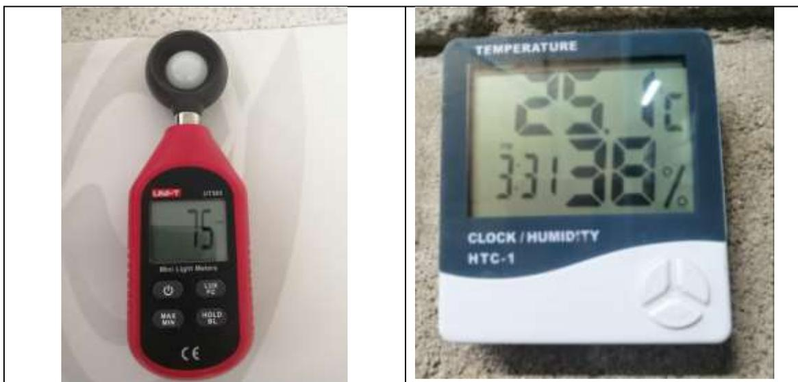
Para poder tomar la humedad y la temperatura se utilizaron elementos como el Medidor Digital De Luz Luxómetro Uni-t Ut-383 0-200.000 Lux, que nos permitió medir los niveles de luz. También el Htc2. Termohigrómetro Digital Sonda Temperatura, Humedad, L, que nos permitió medir los niveles de temperatura y la humedad en cada una de las áreas.
